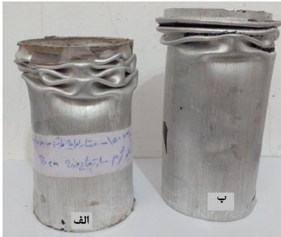
شکل ۱) فروریزش جاذب استوانه‌ای؛ (الف) بدون فشردگی هوا، (ب) همراه با فشردگی هوا
