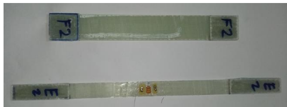
ج) آماده‌سازی نمونه‌ها با اتصال تب‌ها و کرنش‌سنج‌ها بر حسب نیاز (شکل ۱) فرآیند ساخت و آماده‌سازی نمونه‌ها
