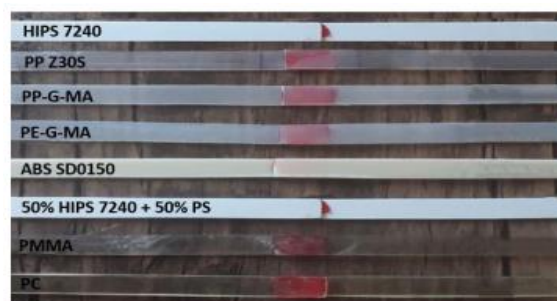
شکل ۲) نمونه‌های تهیه شده برای آزمون برشی لبروی هم
