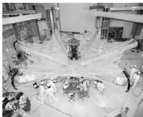
ج. ماهواره HALCA همراه با میله‌های کششی [9]
