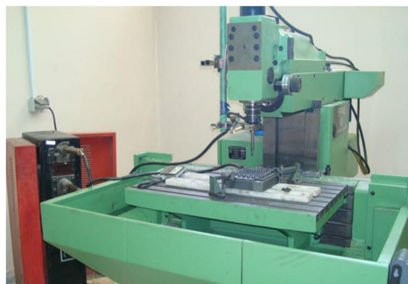
شکل 3 مجموعه‌ی مورد استفاده برای شکل‌دهی نموی گرم الکتریکی ورق
