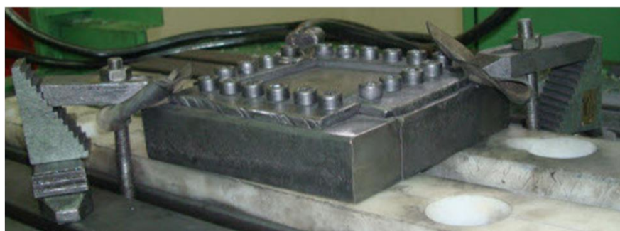
شکل 5 فیکسچر ساخته شده برای شکل‌دهی ورق Ti-6Al-4V
