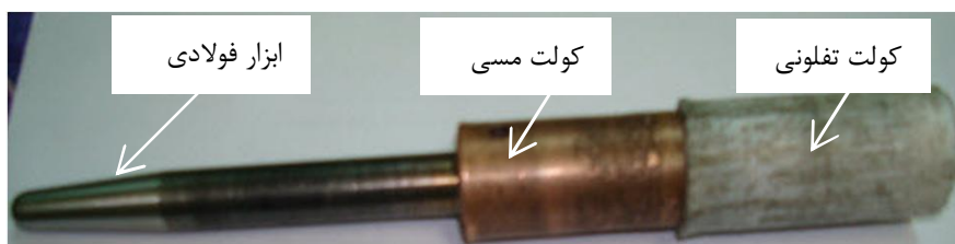
شکل 4 ابزار مورد استفاده به همراه کولت‌های مسی و تفلونی
