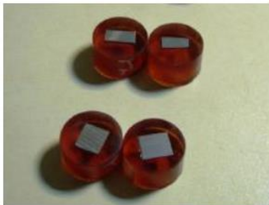
شکل ۸) نمونه های مانت متالوگرافی
