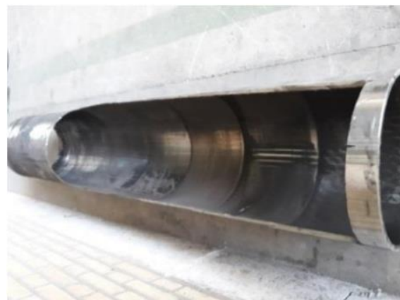
شکل ۶) برش لوله تولید شده برای تهیه نمونه برداری آزمون کشش
