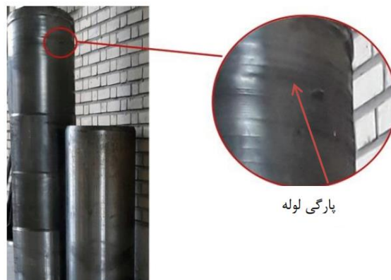
شکل ۵) نمونه پیش تولید و لوله تولید شده
