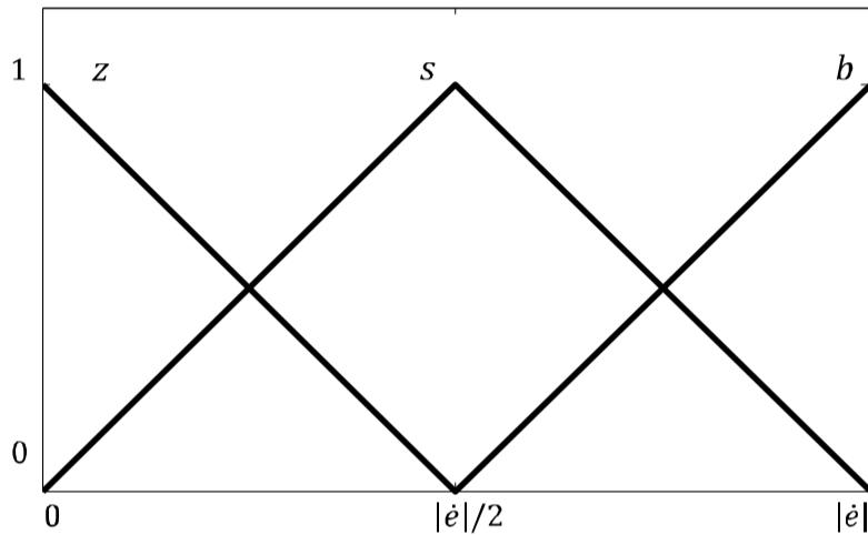
شکل 4 توابع تعقیب مربوط به ورودی اندازه مشتق خطای
