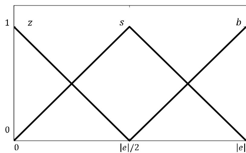
شکل 3 توابع تعقیب مربوط به ورودی اندازه خطای
