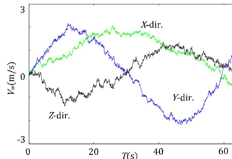
شکل 24 وزش باد سه محوره اعمال شده به هواپیما به همراه توربالنس درایدن
