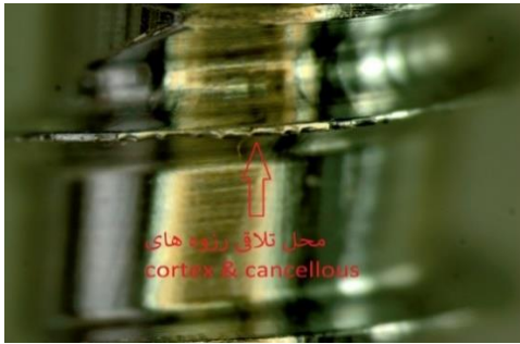
شکل ۹) محل تلاقی رزوه‌های دنده عمیق با رزوه‌های دنده کم عمق در پیچ ستون فقرات ساخته شده توسط فرایند رزوه تراشی گردابی
