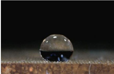
شکل ۸) وضعیت قرارگیری قطره آب بر روی سطح بدون ساختار و سطح ساختاریافته تولید شده به کمک پروسه سنگ‌زنی
