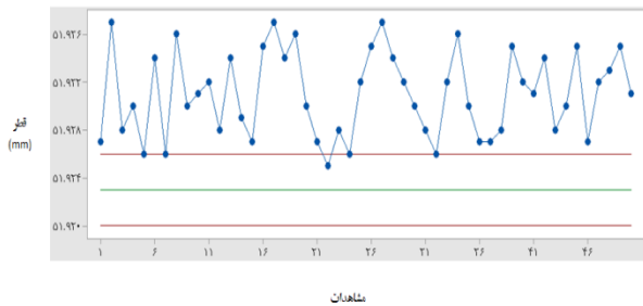
شکل (۴) تغییرات قطر خوانده شده در ۵۰ حالت مختلف توسط دستگاه اندازه گیری موقعیت سه بعدی
