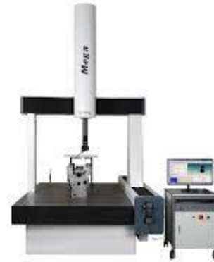
شکل (۱) نمایی از ماشین اندازه گیری موقعیت سه بعدی (CMM)
