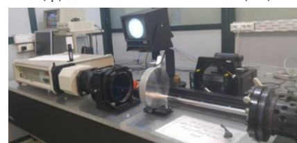
شکل ۱) الف) ابزار نئوتکس ب) نحوه قرارگیری نمونه در فیکسچر مخصوص ج) دستگاه اینترفرومتری زایگو
