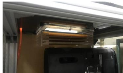
شکل ۲) نحوه چیدمان صفحات جاذب نوری بین منبع نور و بستر ظرف.
