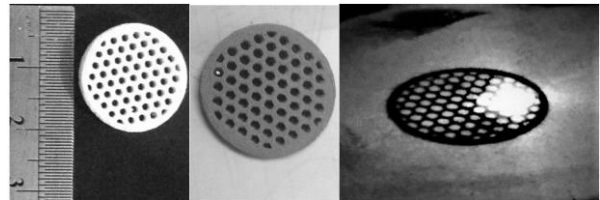
شکل ۸) از چپ به راست نمونه‌ی درحال چاپ، نمونه ساخته شده و نمونه‌ی نهایی با زیرکونیا-ایتریا ۳ مول
