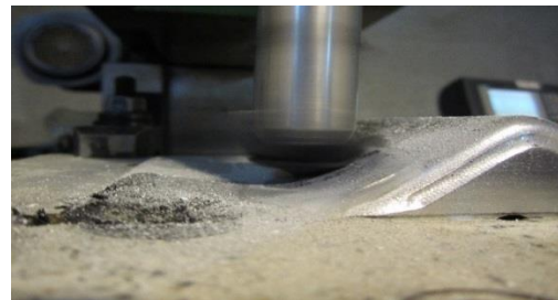
شکل ۱) مسیر استراتژی رستر دو طرفه بر سطح قطعه کار
