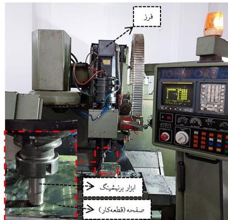
شکل ۳) تجهیزات مجموعه آزمایشگاهی فرآیند برنیشینگ صفحه
