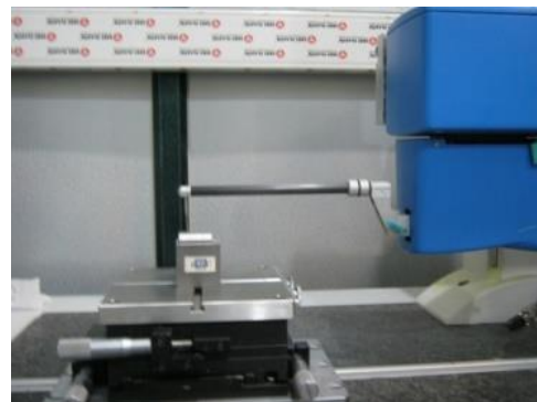
شکل ۳ فرآیند اندازه‌گیری زبری قطعات
