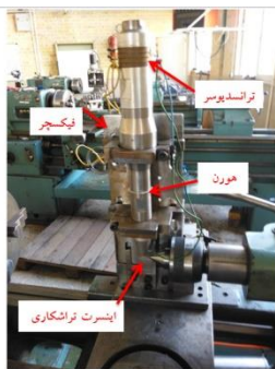
شکل ۲) ابزار ارتعاشی به همراه کله‌گی التراسونیک نصب شده بر روی دستگاه تراش
