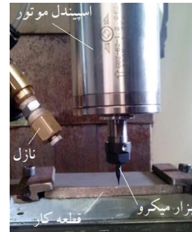
شکل ۲) مجموعه ماشینکاری مورد استفاده در تحقیق
