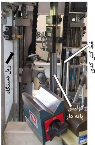
شکل ۶) اندازه‌گیری خطاهای موقعیت‌دهی محورهای حرکتی
