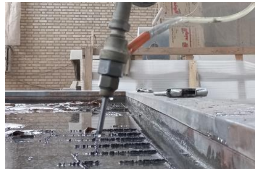
شکل ۳) تنظیم زاویه برخورد جت آب
