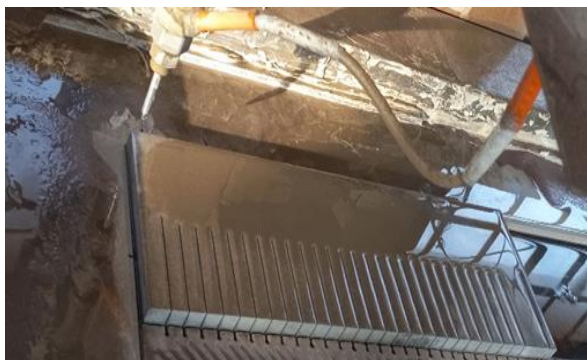
شکل ۲) قطعه کار به همراه شکاف‌های برش
