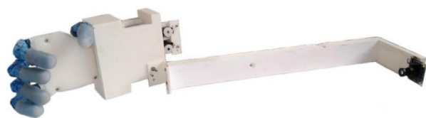
شکل ۸) اتصال دوربین به دست ربات
