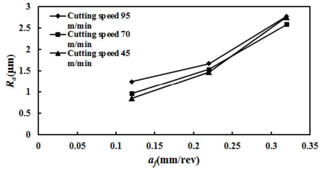
شکل 11 تأثیر تغییرات سرعت پیشروی بر زبری سطح قطعه کار در سرعت برشی ثابت تحت شرایط روانکاری مرطوب
