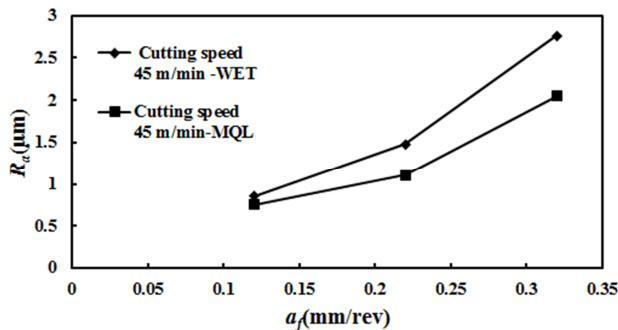
شکل 13 مقایسه میزان زبری سطح دو روش MQL و مرطوب در سرعت برش 45 متر بر دقیقه و سرعت پیشروی متغیر
