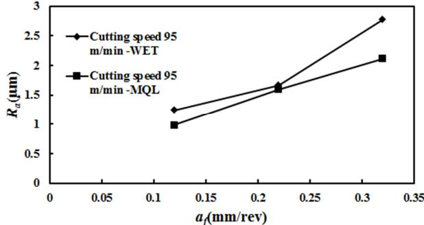
شکل 15 مقایسه میزان زبری سطح دو روش MQL و مرطوب در سرعت برش 95 متر بر دقیقه و سرعت پیشروی متغیر
