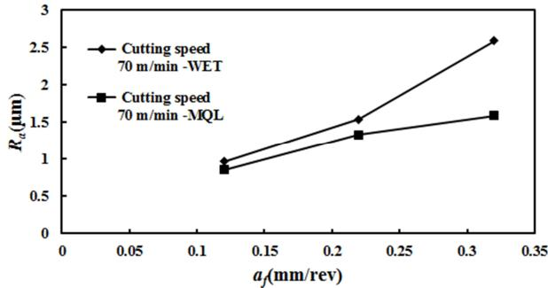
شکل 14 مقایسه میزان زبری سطح دو روش MQL و مرطوب در سرعت برش 70 متر بر دقیقه و سرعت پیشروی متغیر
