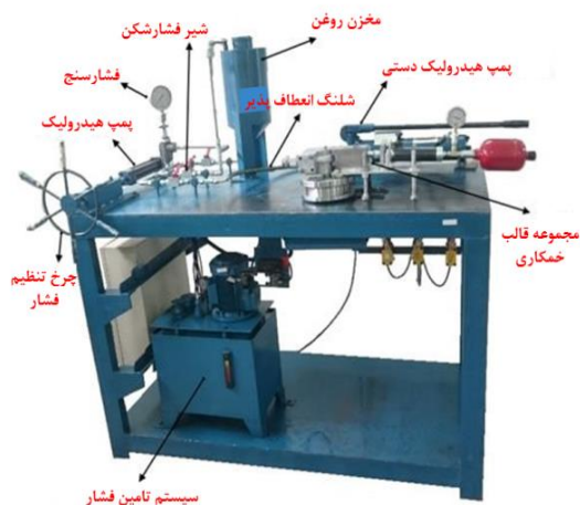
شکل ۳) دستگاه خمکاری دورانی کششی هیدرولیکی استفاده شده
