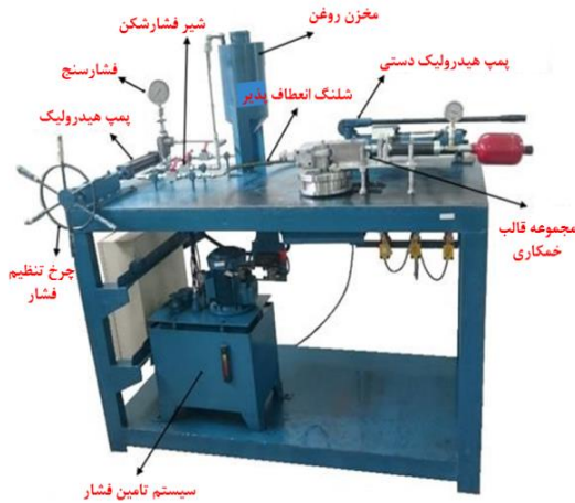
شکل ۳) دستگاه خمکاری دورانی کششی هیدرولیکی استفاده شده
