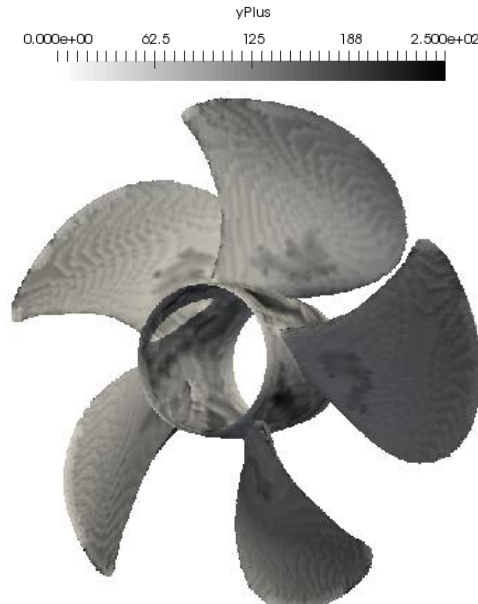
Fig. 6 The y^+ contour on the propeller at the fine grid at J = 1.06 شکل 4 کانتور y^+ روی پروانه با شبکه ریز در حالت J = 1.06
