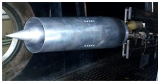
شکل ۲ تصویر مدل نصب شده در تونل باد
