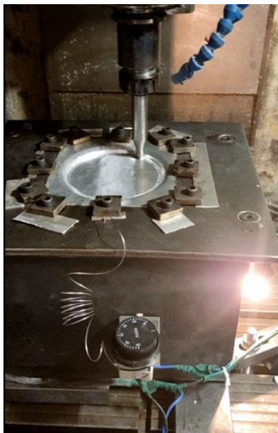
شکل ۲) مجموعه قالب، سیستم گرمایش و ابزار شکل‌دهی تدریجی در حین انجام آزمون تجربی
