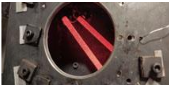
شکل ۱) سیستم گرمایش قالبی ورق‌ها
