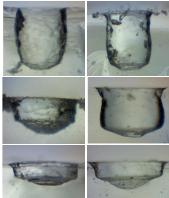
شکل ۴ تصاویر مقاطع سوراخ‌ها در قطرهای مختلف ابزار
