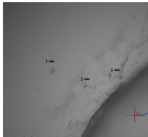
شکل ۷) الف) نقاط اندازه‌گیری سختی
