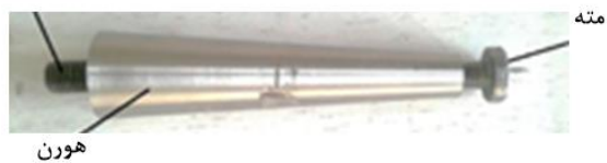
شکل ۱) اتصال هورن و مته به وسیله پیچ
