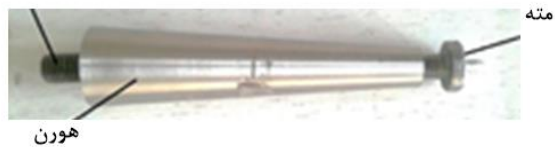
شکل ۱) اتصال هورن و مته به وسیله پیچ
