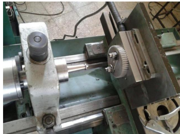
شکل ۲) مجموعه ابزار سوراخ‌کاری ارتعاشی
