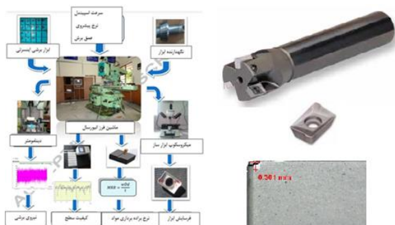
شکل ۲) لبه برشی ساییده شده و نمونه اینسرت و ابزارگیر مورد استفاده
