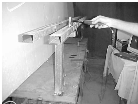
شکل ۸ پل تحت آزمایش مودال کلاسیک
