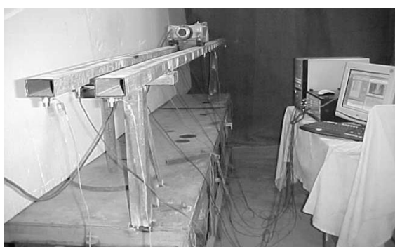
شکل ۱۰ پل تحت آزمایش مودال محیطی (مرحله چهارم آزمایش)
