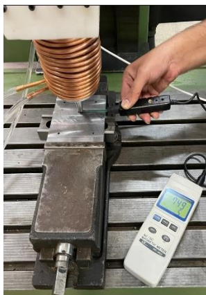
شکل ۶) چگالی شار مغناطیسی، (الف) نتایج اندازه‌گیری و شبیه‌سازی (ب) نحوه اندازه‌گیری با گوس‌متر
