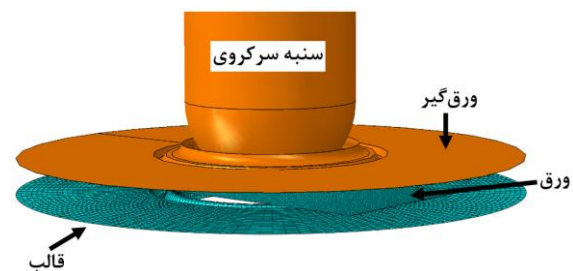
شکل ۴) اجزای قالب شکل‌دهی در شبیه‌سازی
