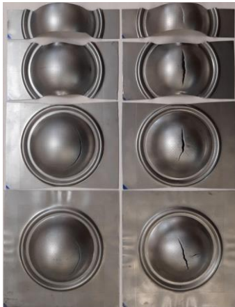
شکل ۸) نمونه‌های شکل داده شده در شکل‌دهی شبه‌استاتیک (چپ) و شکل‌دهی ضربه‌ای (راست)
