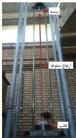
شکل ۳) چیدمان آزمایش شکل‌دهی توسط دستگاه سقوط وزنه
