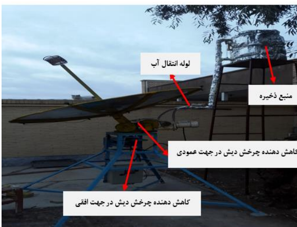
شکل (۲) ساخت دیش سهموی خورشیدی و اجزاء مربوطه
