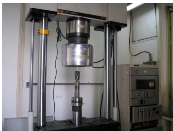
Fig. 11 Fatigue test machine INSTRON 1343 شکل 11 دستگاه تست خستگی اینسترون 1343
