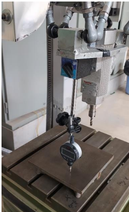
شکل ۹) تنظیمات انجام شده برای استحصال میزان خطای مستقیم بودن با ساعت اندیکاتور ۰/۰۰۱ میلی‌متر
