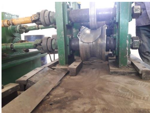
شکل ۵) انجام عملیات شکل دهی بر روی ورق
