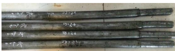
شکل ۸) لوله‌های کشش شده
