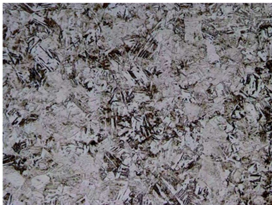
شکل ۱) ریزساختار اولیه فولاد ۴۱۰ مورد استفاده در مطالعه حاضر که تایید کننده ساختار اولیه مارتنزیتی است.
