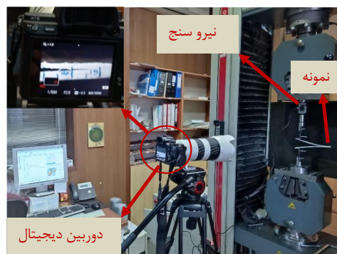
شکل ۲) نمونه تیریکسرگیردار دوبله در حین آزمون و تجهیزات آزمون مود اول شکست
