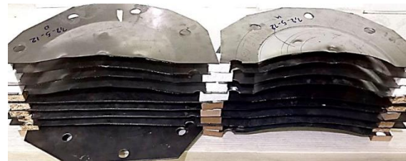
شکل ۷) ورق‌های فوقانی و تحتانی متناظر در سازه‌ها (بترتیب از راست) مربوط به آزمایش‌های تجربی انجام شده
