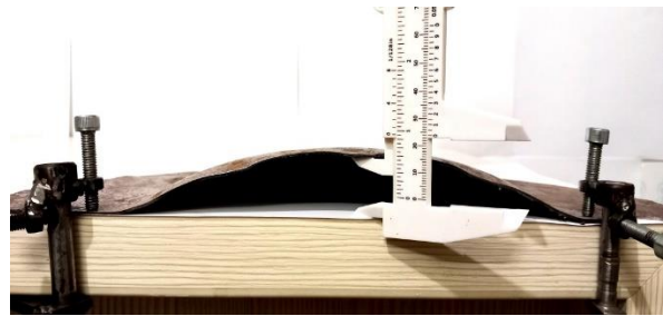
شکل ۶) بیشینه جابجایی مرکز ورق فوقانی تست (۲۲)
