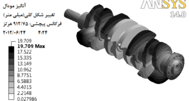
شکل ۱۰ فرکانس پیچشی اول میل‌لنگ GLX
