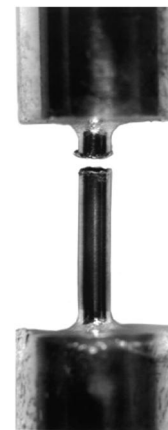
شکل 17 مینی کانال دچار ذوب و از هم گسیختگی بواسطه شار حرارتی بحرانی بالا [22]
