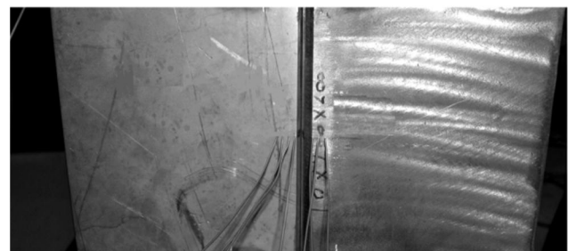
شکل 3 اتصال ترموکوپل‌ها به قطعه به صورت تجربی
