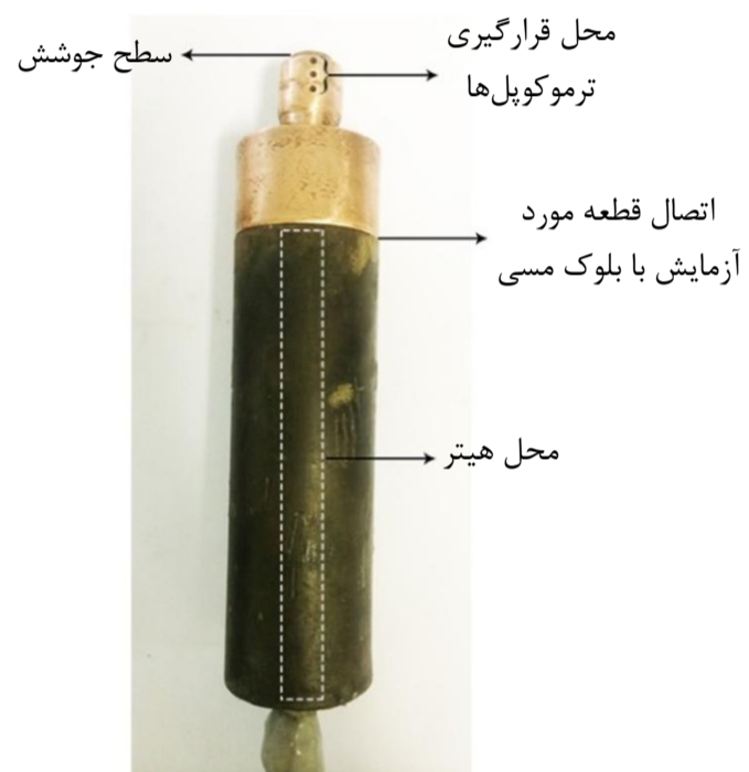
شکل 2 نمای بلوک مسی و قطعه مورد آزمایش
