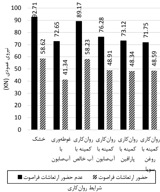
شکل ۳ نیروی عمودی سنگ‌زنی در شرایط مختلف روان کاری، بدون حضور و با حضور ارتعاشات فراصوت
