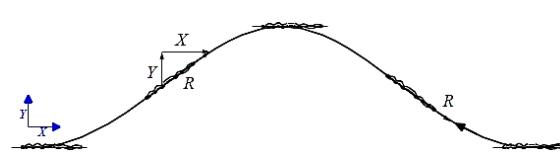
Fig. 3 رژیم خنثی ( $\chi = 1$  و  $\alpha_{T/4} = 0$ ). حرکت ظاهری ایرفویل از راست به چپ و بردار سرعت موثر بر مسیر ظاهری منطبق است
