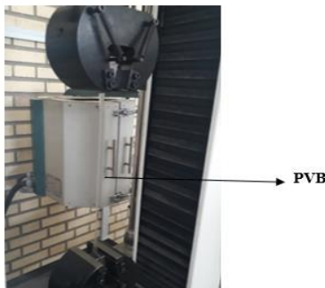
شکل ۳) نمونه PVB در حین آزمایش کشش
